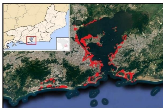
Figura 6 – Áreas aterradas sobre o mar, lagoas, pântanos e mangues (Adaptado de ANDREATTA et al. 2009. AMADOR, 2013).
